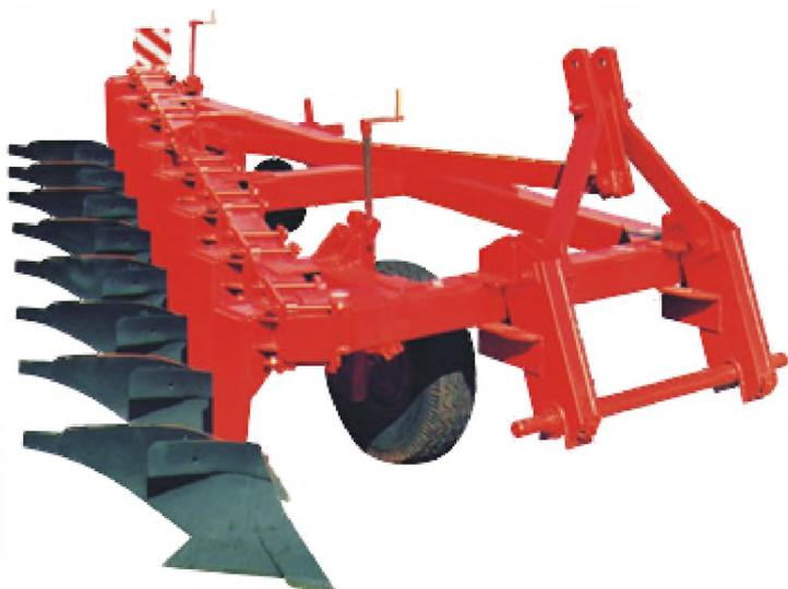
Плуг 8-ми корпусный навесной ПН-8-35У предназначен для пахоты под зерновые и технологические культуры на глубину до 27 см, не засоренных камнями, плитняком и другими препятствиями, с удельным сопротивлением до 0,1 Мпа (1,0 кгс/см<sup>2</sup>).
