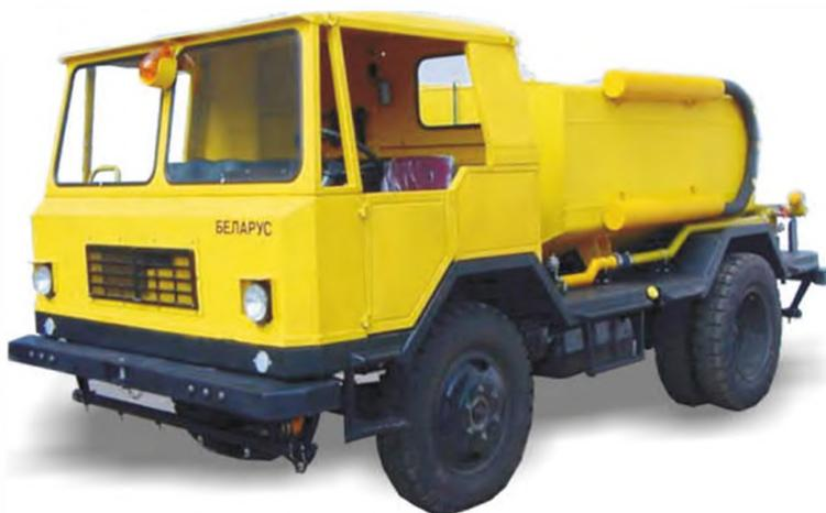
Машина поливочная шахтная «Беларус» МПЛ-373М2 предназначена для поливки горных выработок и тушения пожаров в подземных рудниках арочного типа.
