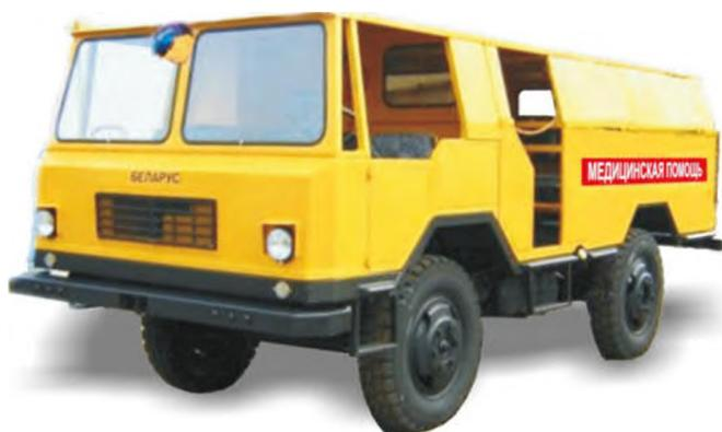
Машина медицинской помощи шахтная «Беларус» ММП-393М2 предназначена для доставки специально подготовленного персонала и необходимого оборудования на место происшествия, оказания медицинской помощи и транспортировки больных или пострадавших к стволу в подземных рудниках по горизонтальным и наклонным горным выработкам арочного типа.
