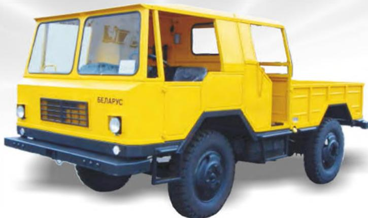
Машина грузоподъемная шахтная «Беларус» МГЛ-363М2 предназначена для перевозки людей и грузов по горизонтальным и наклонным горным выработкам арочного типа.
