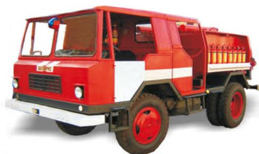
Машина пожарная шахтная «БЕЛАРУС» МП-403М2 предназначена для доставки боевого расчета из шести человек на место пожара и его тушения в подземных рудниках арочного типа.
