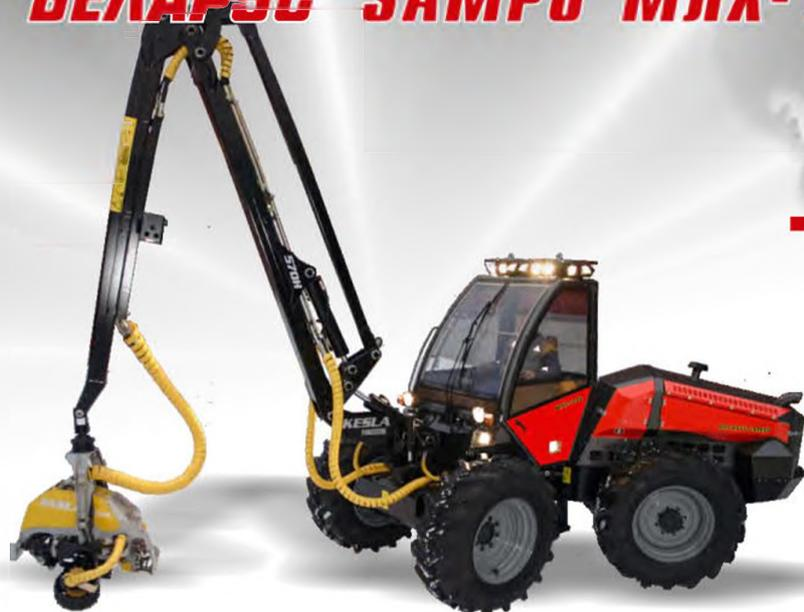
■ Машина лесная харвестер «БЕЛАРУС-САМРО» МЛХ-1046 предназначена для выполнения валочно-сучкорезно-раскряжевых работ на рубках ухода.
